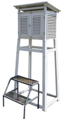
Es una casilla de madera con paredes de celosía, se pinta de color blanco para evitar que la radiación solar afecte los instrumentos instalados dentro y el diseño tanto del techo como de las paredes garantiza la seguridad de los instrumentos que están en su interior.
