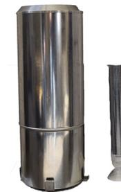
Es el instrumento que se utiliza para medir la cantidad de lluvia precipitada. La unidad de medida es en milímetros, 1 mm de precipitación significa que precipitó 1 litro de agua por metro cuadrado.
