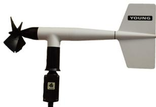
El Anemómetro es el instrumento que se utiliza para medir la intensidad y dirección del viento en superficie. Existen diferentes tecnologías de medición, como por ejemplo: el anemómetro de cazoletas o hélice que hacen una medición mecánica, y el anemómetro ultrasónico que realiza la medición utilizando la velocidad de propagación del sonido.
