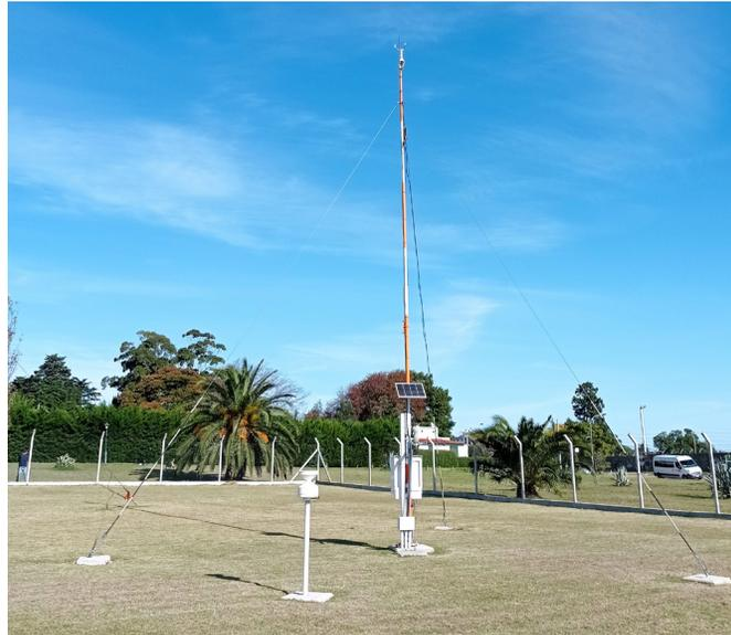
Está compuesta por un sistema de adquisición de datos el cual tiene conectados sensores de medición de variables meteorológicas como por ejemplo pluviómetro, anemómetro, sensor de temperatura y humedad, pluviómetro, sensor de radiación solar.
