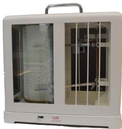
Un sistema de palancas amplifica y transmiten los movimientos de cada sensor a dos brazos que en su extremo tienen una pluma o grafo.
