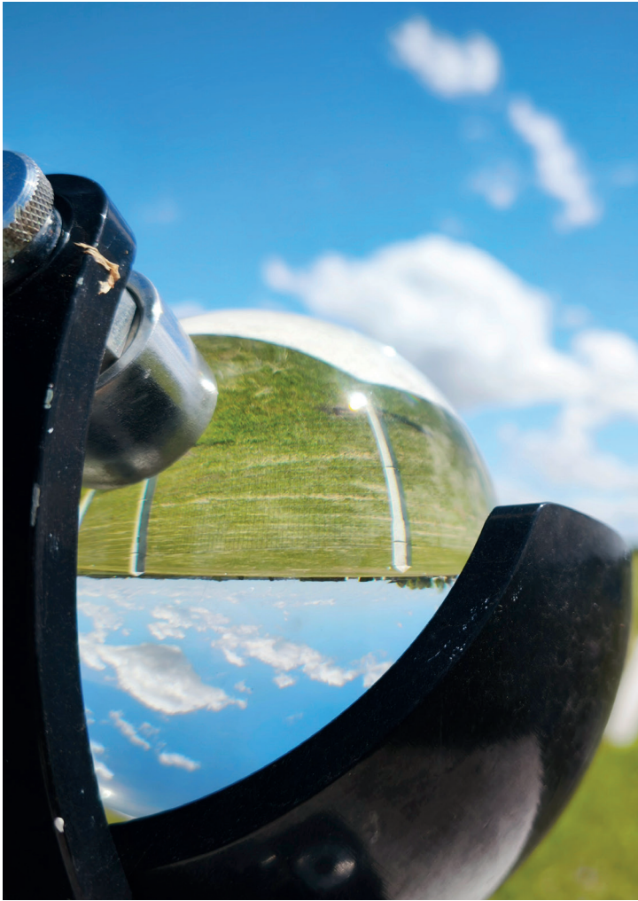
Estación Meteorológica Paysandú - Heliógrafo: registra horas de sol. Autoría: Pablo Castañero.
