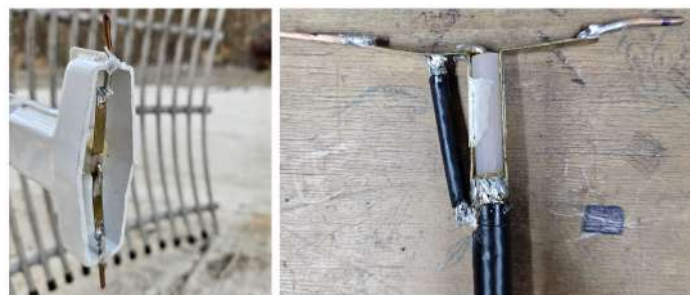
Fig. 3. Modificaciones realizadas a la antena. Dipolo (izq.) y Balun (der.).
